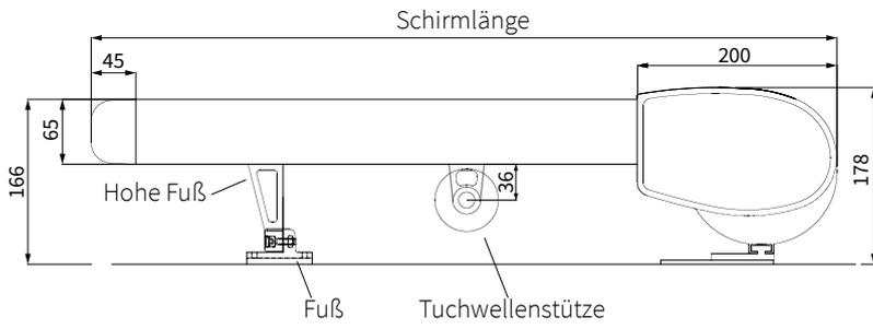
Abb. 1 Seitenansicht Abmessungen
