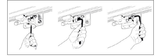
16) Mit Hilfe eines Maulschlüssels lösen (Verringern des Neigungswinkels) oder Ziehen Sie (Vergrößern des Neigungswinkels) die Einstellschraube fester, um den Neigungswinkel zu ändern.
