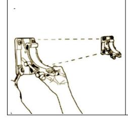
10) Hängen Sie die Markise in die Halter, so dass die Kassette maximal an die Halter gedrückt wird (Achtung – vor dem Einhängen ist zu prüfen, ob alle Halter sich im Lot befinden und auf einer ebenen Fläche montiert sind).
