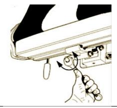
17) Prüfen Sie mit Hilfe der Wasserwaage, ob das Fallprofil sich im Lot befindet.
