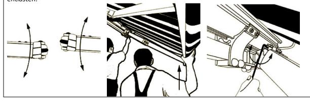
14) Prüfen sie mit Hilfe der Wasserwaage, ob die Gelenkarme in einer Ebene zueinander schließen.
