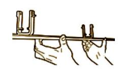
16) Befestigen Sie die Profilverblendung am quadratischen Profil 40x40 mit Hilfe der M8x70 Schrauben.
