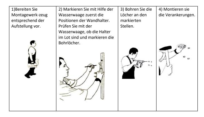
5) Die Montage der Wandhalter ist nur in den Varianten wie in den Zeichnungen unten dargestellt, zulässig: Verwendung aller 3 Löcher, des Oberen und des Unteren Lochs oder des Mittleren und des Unteren Lochs.
