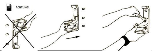
6) Analog zum ersten Halter (Basis) bestimmen Sie die Position der restlichen Wandhalter und montieren diese. Achten sie besonders darauf, dass alle Halter in einer Ebene und auf einer ebenen Wandfläche montiert werden.
