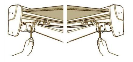
19) Prüfen Sie mit Hilfe der Wasserwaage, ob das Fallprofil sich im Lot befindet.
