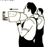
11) Sichern Sie das quadratische Markisenprofil mit Hilfe der Schraube M8x65 und montieren anschließend die Kunststoffabdeckung.
