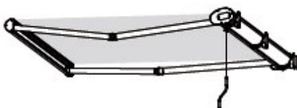
13) Prüfen Sie mit Hilfe der Wasserwaage, ob die Gelenkarme in einer Ebene zueinander schließen. Sollten Sie Einstellungen an den Gelenkarmen oder dem Neigungswinkel vornehmen, muss eine Person die Gelenkarme durch leichtes Nach-Oben Drücken entlasten.
