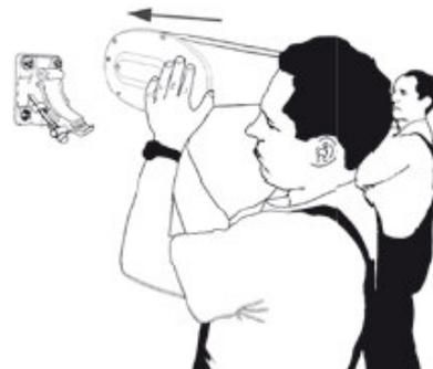
11) Sichern Sie die Kassette mit Hilfe der Schraube auf der unteren Seite.
